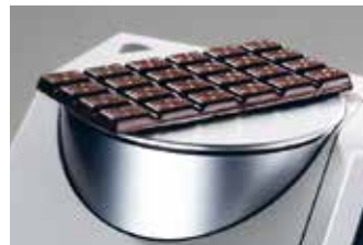
Reflexions-Messung von Feststoffen
