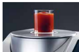
Mesure de pâtes en réflexion
