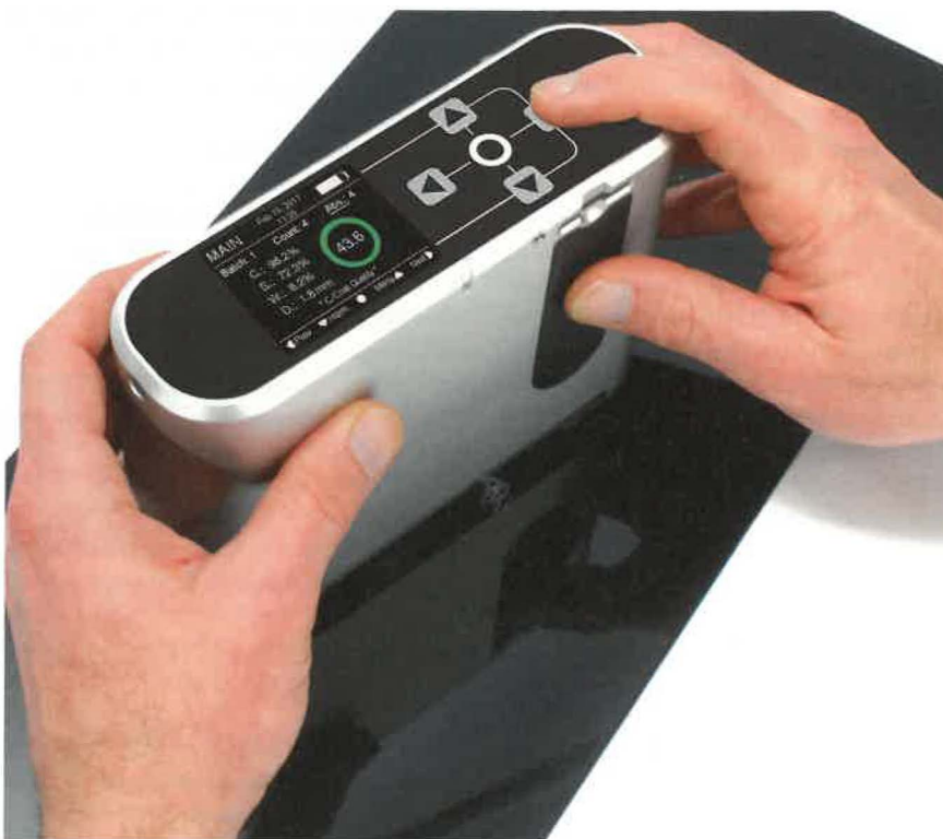
Das neue Messgerät imitiert das menschliche Auge und erfasst Bilder auf unterschiedlichen Schärferebenen. Mit Hilfe von Algorithmen werden daraus die Eigenschaften berechnet.
